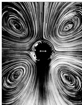
Рис. 6.2. Вторичные вихри, индуцируемые колеблющимся цилиндром. Течения вокруг цилиндра подобны течениям вокруг Солнца как центробежного насоса.
