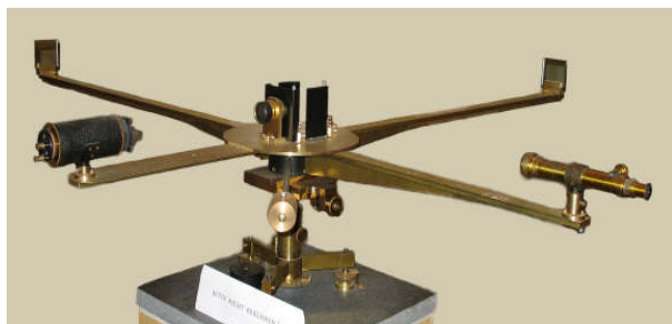
Музейная реконструкция установки Майкельсона в подвале обсерватории на Telegraphenberg в Потсдаме (оригинальное устройство уже не существует).
